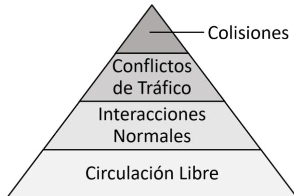
Figura 1. Modelo piramidal de seguridad basado en el modelo clásico de Hydén (1987).
