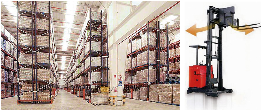
Figura 33. Ejemplo de estanterías de seis alturas y carretilla trilateral.
