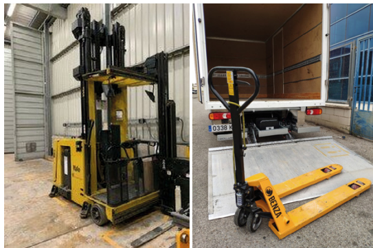
Figura 40. Ejemplo de carretilla trilateral (izquierda) y transpaleta manual (derecha).
